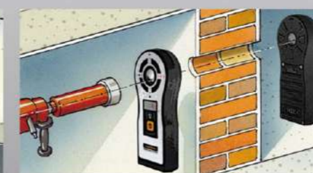
壁面穿孔時の始点・終点の確認、壁厚の測定。 床面の高さが異なる場合でも使用可能。
