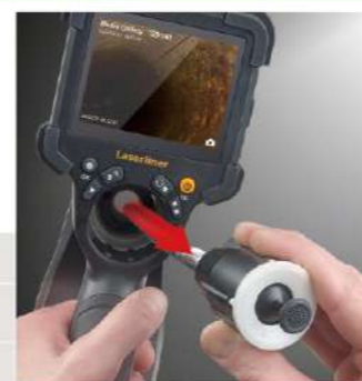
脱着可能なカメラケーブル 破損時にもすぐに交換可能
